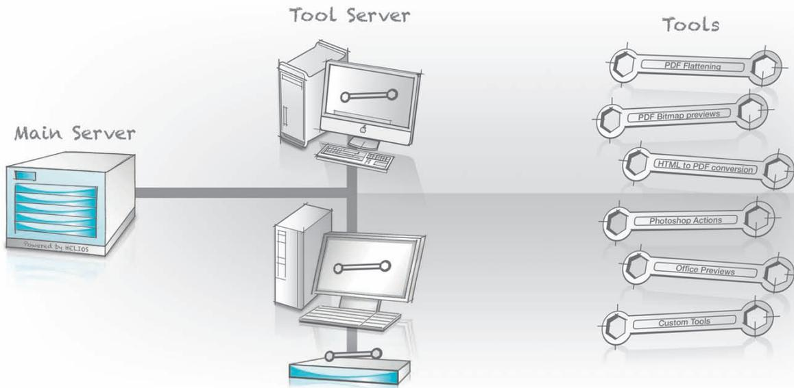
Mit **Tool Server UB64** können Anwendungsprogramme, die auf Netzwerk-Clients laufen, automatisiert und vom HELIOS Server von einem anderen Ort aus („Remote“) genutzt werden. Denn viele Anwendungen und Technologien sind nur auf einer bestimmten Plattform verfügbar. Tool Server ermöglicht Ihrem HELIOS Server deren Nutzung als selbstständigen Prozess oder zur Integration in den Workflow des Servers.
