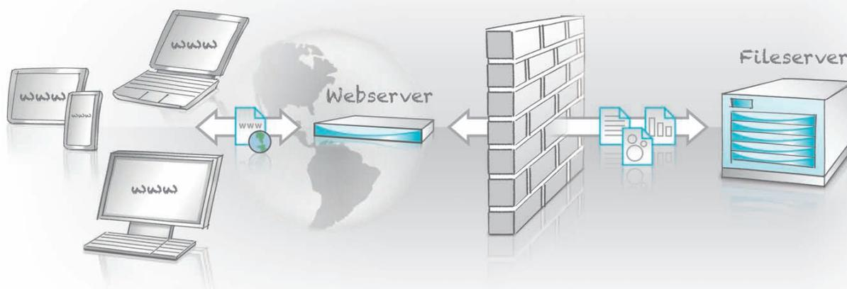
**HELIOS WebShare UB64** bietet einen schnellen und sicheren Datenzugriff über den Webbrowser. Bei entsprechenden Zugriffsrechten können Anwender nun überall dort ihren Fileserver benutzen, wo ihnen ein Internetzugang zur Verfügung steht, ohne dass der Server selbst dem Internet ausgesetzt werden muss.
