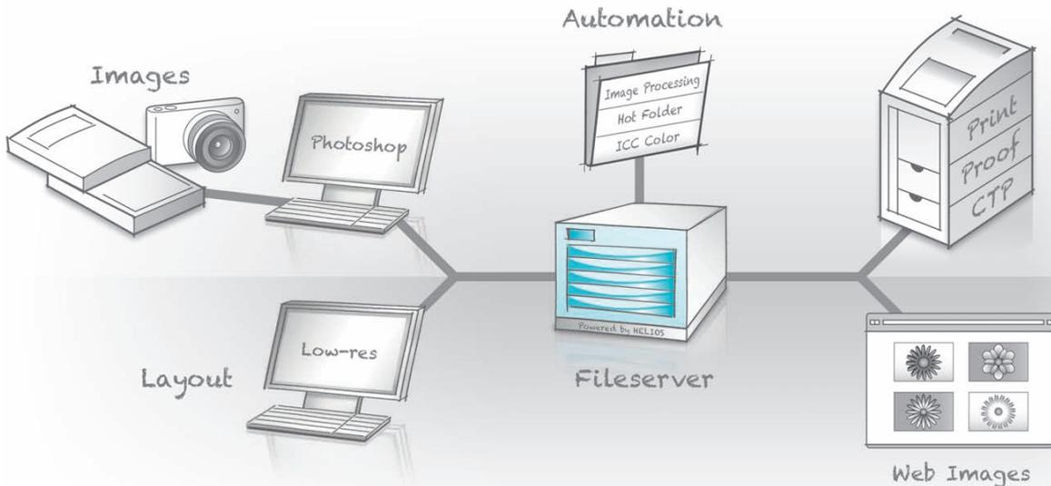
**HELIOS ImageServer UB64** ist eine serverbasierte Lösung zur Konvertierung von Bilddateien, ICC-Farbmanagement und OPI-Bildersetzung mit integrierter Prozessautomatisierung. Die Software unterstützt die wichtigsten Bildformate und Farbräume sowie XMP, EXIF, Beschneidungspfade und ICC-Metadaten. Verarbeitungsprozesse können über so genannte „Hot Folder“, CLI-Programme und OPI-Mehrfachnutzung automatisiert werden. Rechenintensive Aufgaben werden damit vom Arbeitsplatz auf den Server verlagert.
